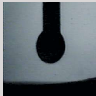
传统的电源 焊接结束时焊丝端结球
