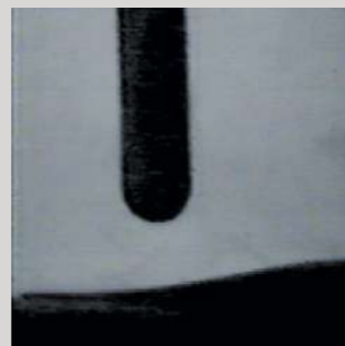
数字化电源 焊接结束时焊丝端无结球
