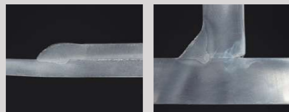
碳钢搭接焊缝，3 mm Vweld 200 cm/min Vweld total 24 m/min
