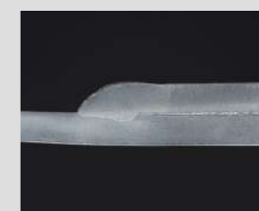
碳钢搭接焊缝, 3 mm Vweld 200 cm/min Vweld total 24 m/min
