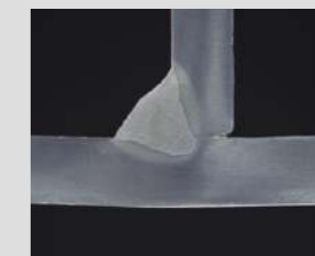
Vweld 150 cm/min Vweld total 26 m/min
