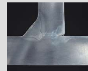
碳钢角焊缝, 3 mm Vweld 120 cm/min Vweld total 24 m/min
